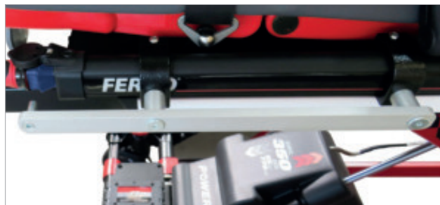
INX-NS Normschiene am seitlichen Rahmen montiert
