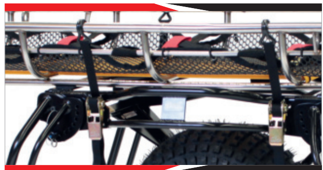
Mit kräftigen Spanngurten wird die Korbtrage auf dem Mule II gesichert.
