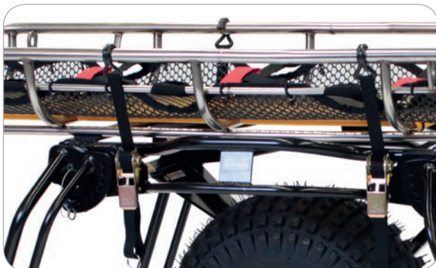
Mit kräftigen Spanngurten wird die Korbtrage auf dem Mule II gesichert.
